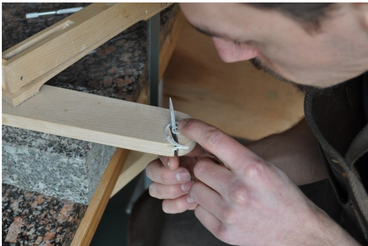
Ajustement des pièces avec une « lime aiguille ».
