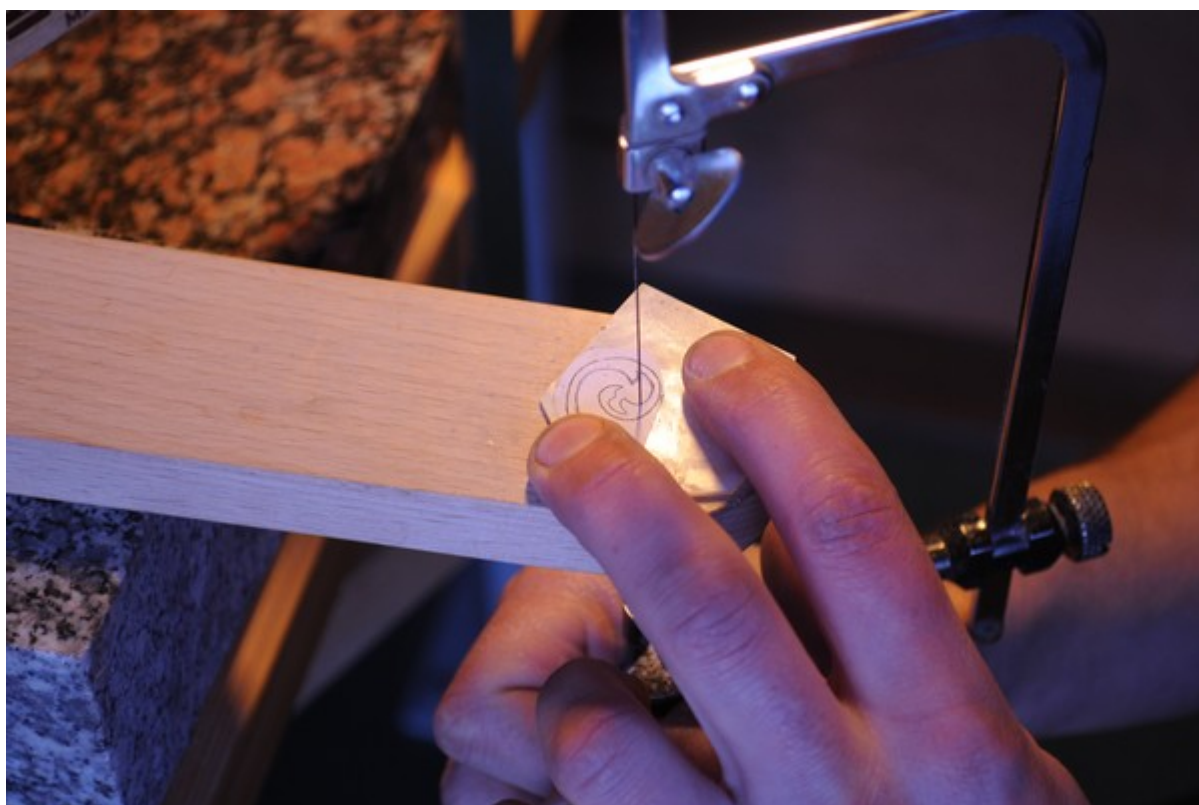
Découpage des pièces avec une scie de joaillier (épaisseur de lame : 0,3 mm).
