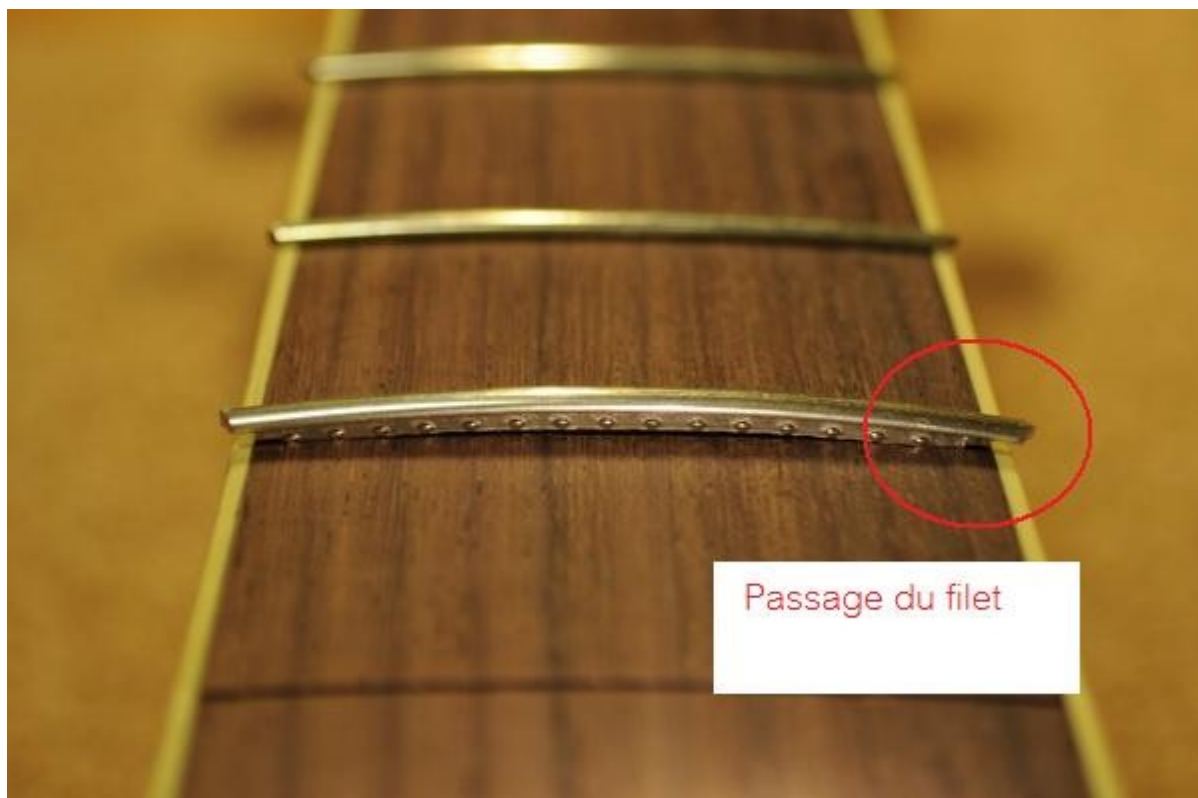
Mise en position de la frette.
